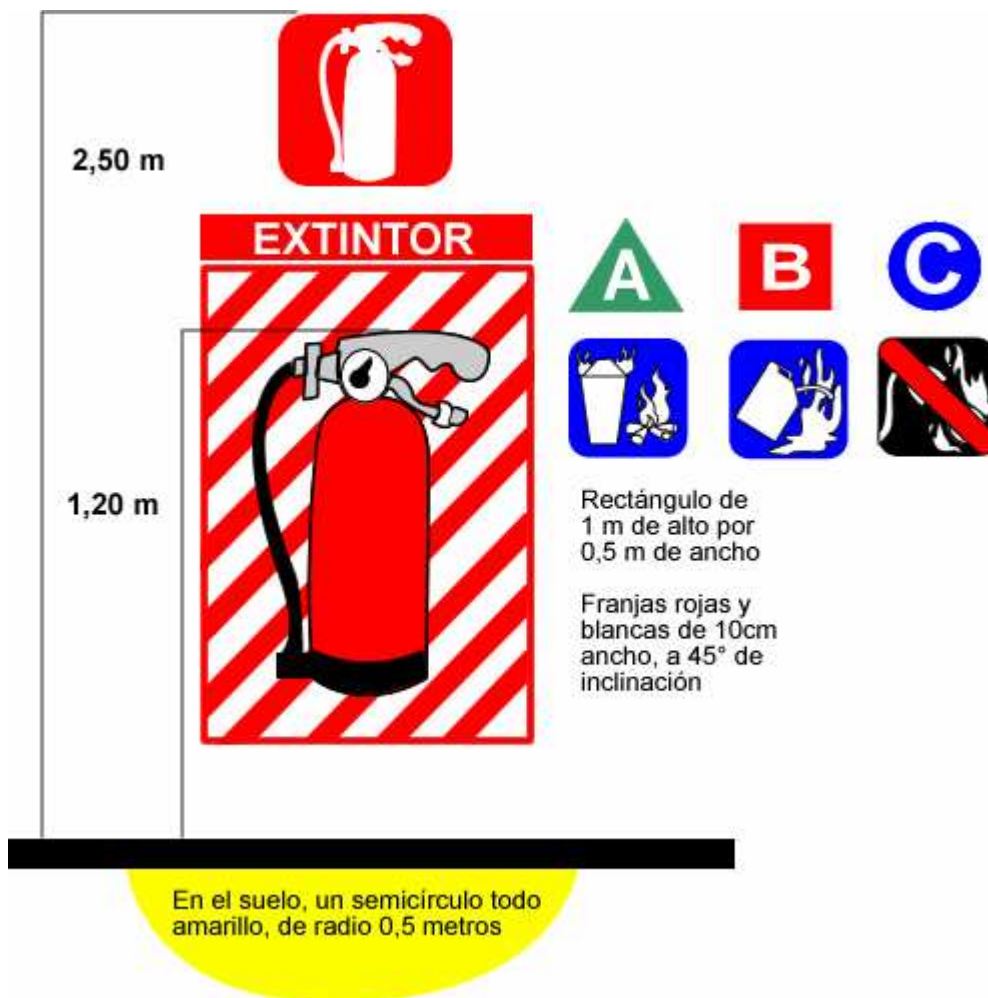
Figura 1. EJEMPLO DE SEÑALIZACIÓN PARA UBICAR EL EXTINTOR
